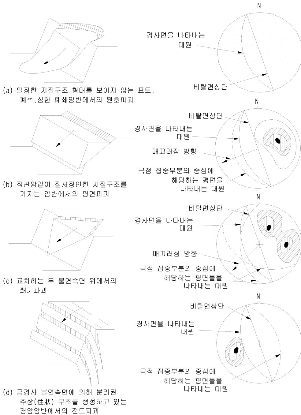
[그림 11.6] 암반사면의 파괴 유형별 평사투영해석 예시
